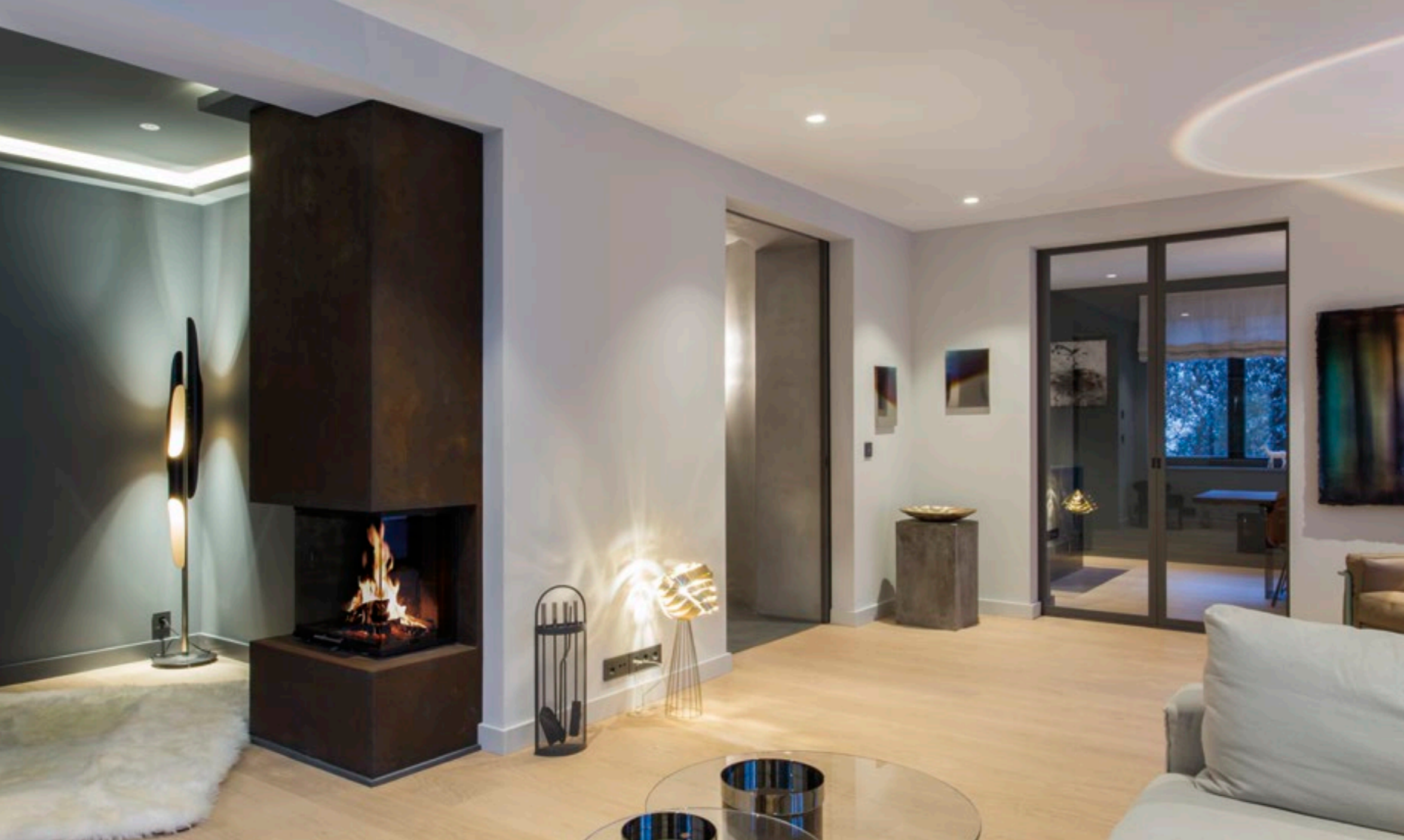
Die Kaminoberfläche zeigt sich in abgefahrener Rostoptik und wurde in der Spachteltechnik wand16 rough hergestellt
