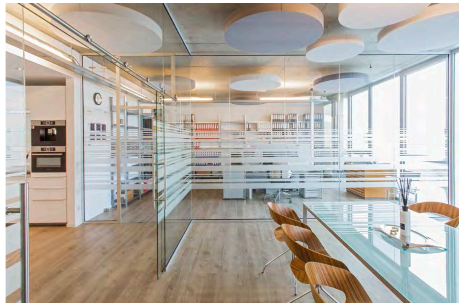
Aus akustischen Gründen wurde der Buchhaltungsbereich im Büro mit einer Zargentür versehen
